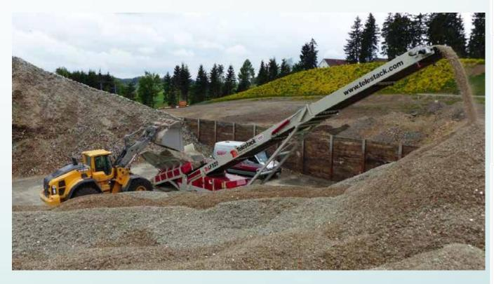
Mit Radlader, ohne Rampe, flexibel von 2 m auf 9 m Halden auf beengten Plätzen oder in Hallen aufgesetzt durch TELESTACK LF 520.
