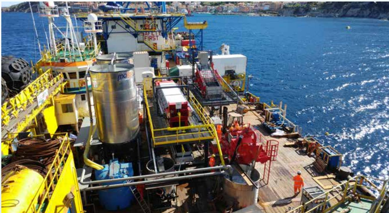
Die Aufbereitungsanlage aus salzwasserresistentem Edelstahl, bestehend aus Waschsieb, Zyklonabscheider mit Entwässerungssieb und Kammerfilterpresse trennt und reinigt den Meeresboden auf dem schwimmenden Bergungsschiff.
