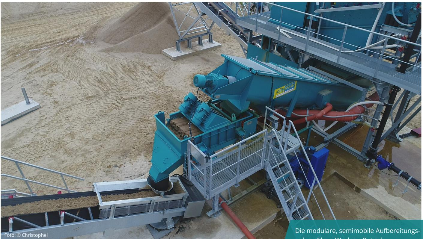
Die modulare, semimobile Aufbereitungsanlage Clean Wash im Betrieb
