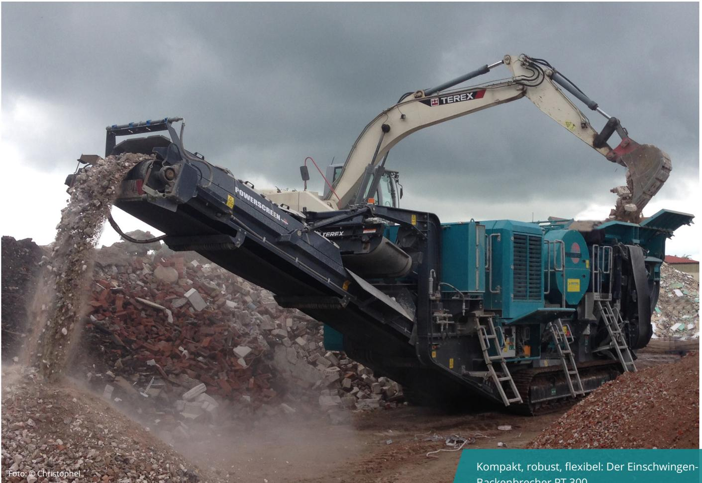
Kompakt, robust, flexibel: Der Einschwingen-Backenbrecher PT 300
