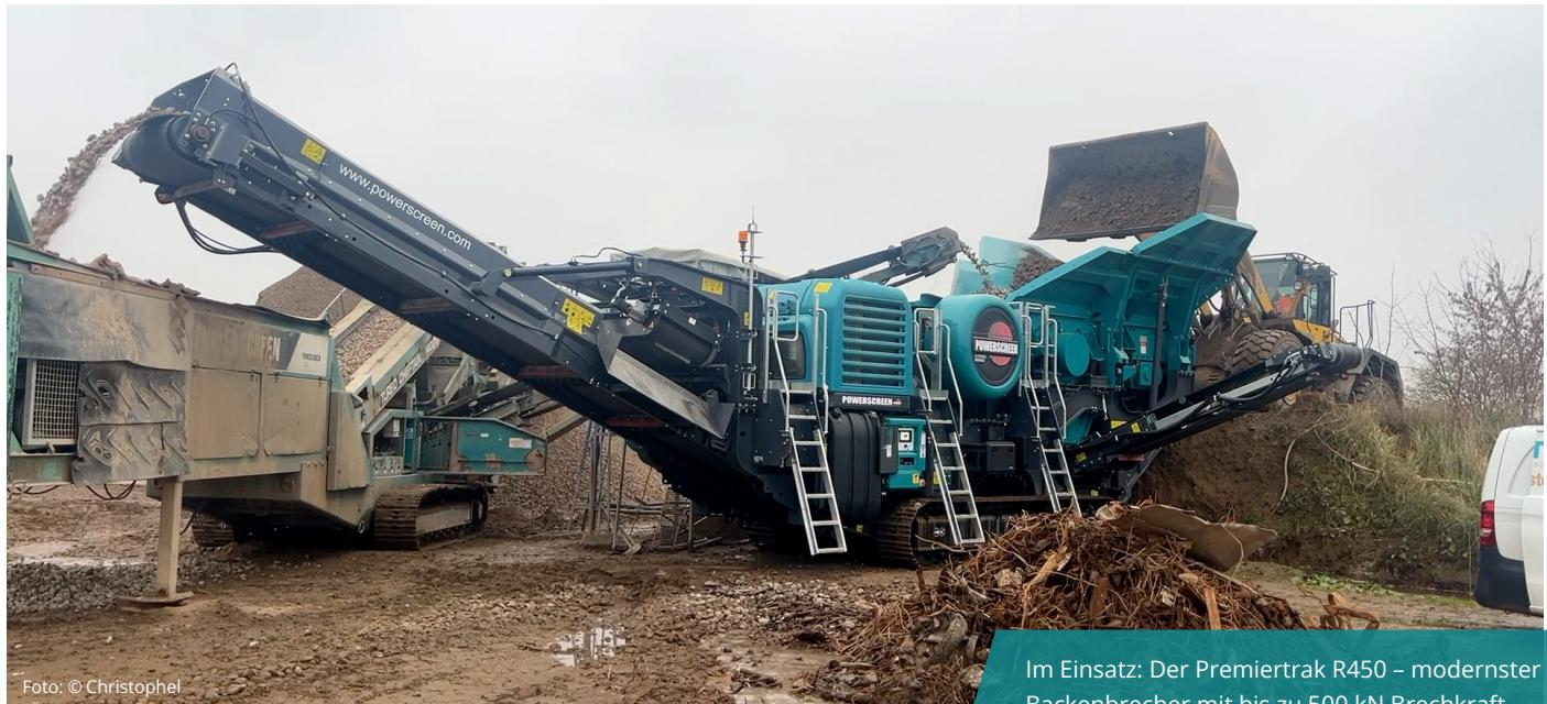
Im Einsatz: Der Premiertrak R450 – modernster Backenbrecher mit bis zu 500 kN Brechkraft
